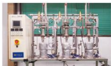
設計圧力:229MPa、常用圧力:125MPa、設計温度:110℃、常用温度:110℃ 電源:単相200V 60Hz 40A、動作音:700mm/s
